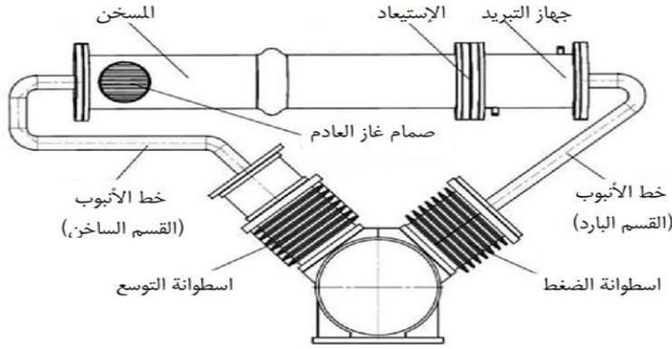
الاسطوانة الساخنة متصلة بمصدر حرارة خارجي. ينقل هذا المصدر الحرارة إلى غاز الأسطوانة الساخن. في المقابل، تحتوي الاسطوانة الباردة على جهاز تبريد. يستخدم جهاز التبريد هذا لاستخراج الحرارة التي تتلقاها أسطوانة الغاز. يتم توصيل الأسطوانتين بواسطة أنبوب حيث يتم نقل الغاز الساخن من الأسطوانة الساخنة إلى الأسطوانة الباردة والعكس صحيح. هذه المحركات لديها القليل من القوة. لذلك، يتم استخدامها لأغراض التحميل الخفيف. يحتوي محرك ألفا على مكبسين للطاقة.
